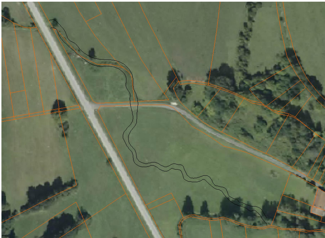
Plan de récolement du nouveau lit du ruisseau des Sept Fontaines par rapport au cadastre
