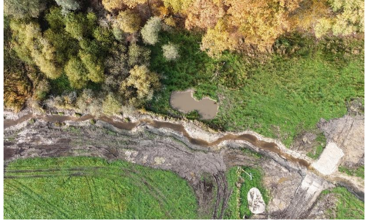
Sur cette vue aérienne, le nouveau lit en eau et après recharge alluvionnaire. On perçoit bien les sinuosités du lit mais également les fosses et radiers. Sont également visibles un passage à gué façonné et une mare créée dans la pâture près d'une saulaie.
